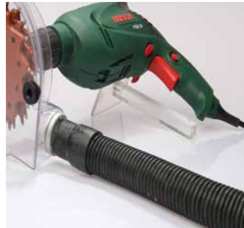
Anschluß Schlauch an Absaugstaubschutz
